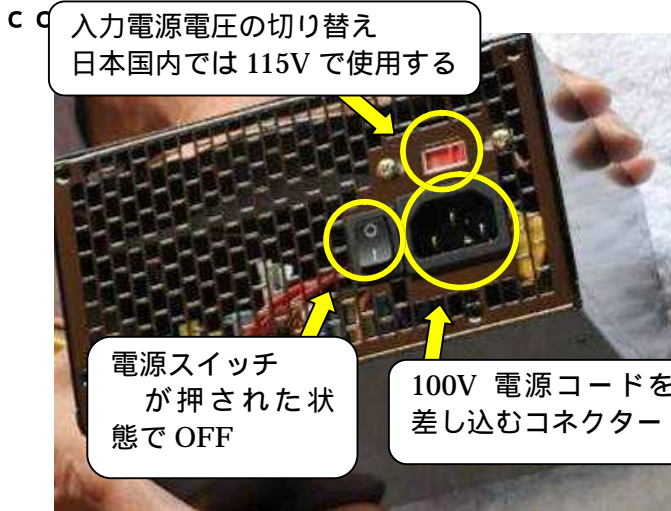
電源ユニットの裏面
