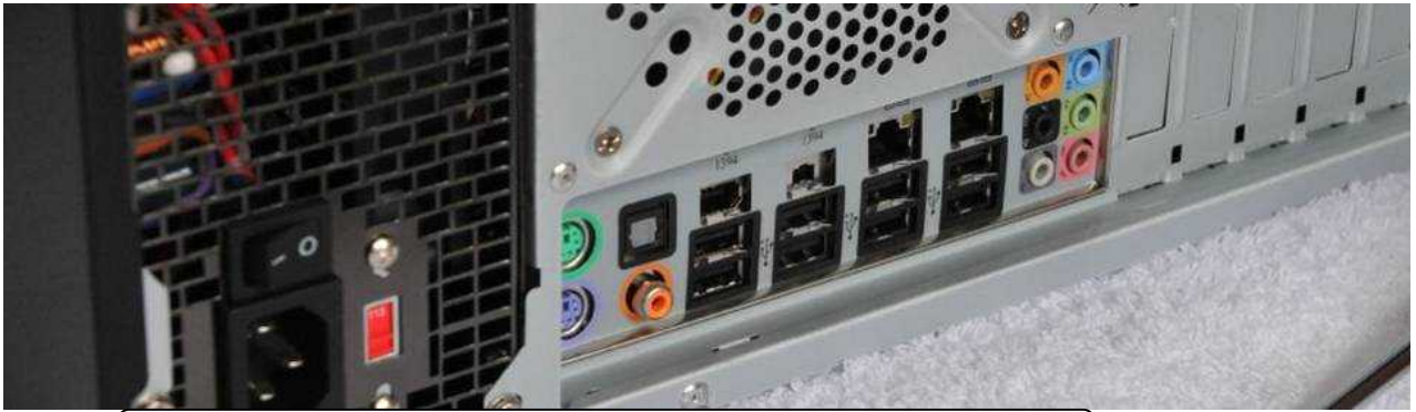
ケース背面の I/O パネルにコネクタが見えているのを確認する
